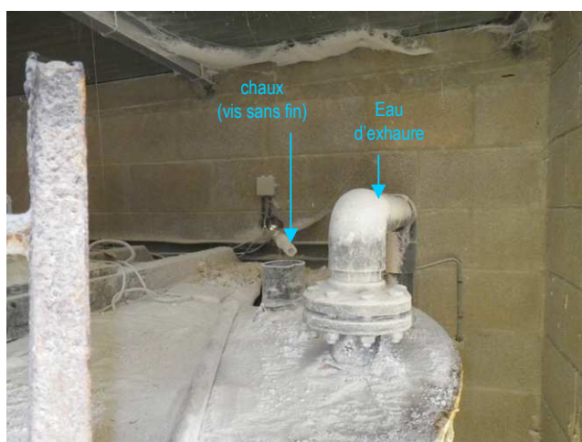
Arrivée des eaux d'exhaure dans la cuve mélangeur
