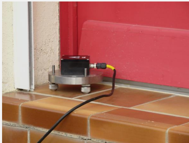
Figure 5 : sismographe de contrôle à La Landrais (photo commissaire enquêtrice)
